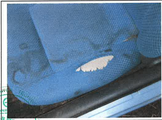
Fot.10. Uszkodzona tapicerka fotela PL
