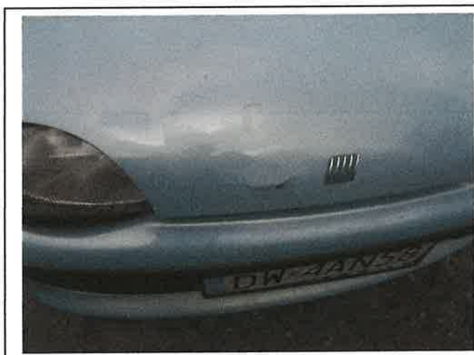
Fot.13. Uszkodzona pokrywa komory silnika
