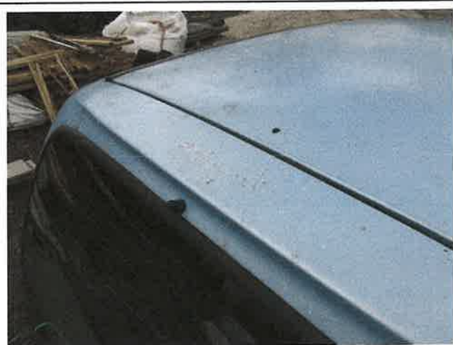
Fot.20. Uszkodzony dach oraz pokrywa komory bagażnika
